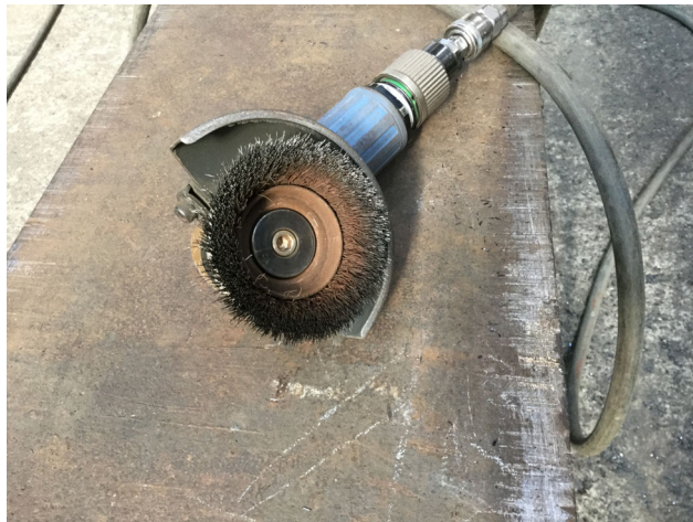
使用できるワイヤカップブラシの例(真鍮製) ※外観検査に支障がないことを確認できたもの
