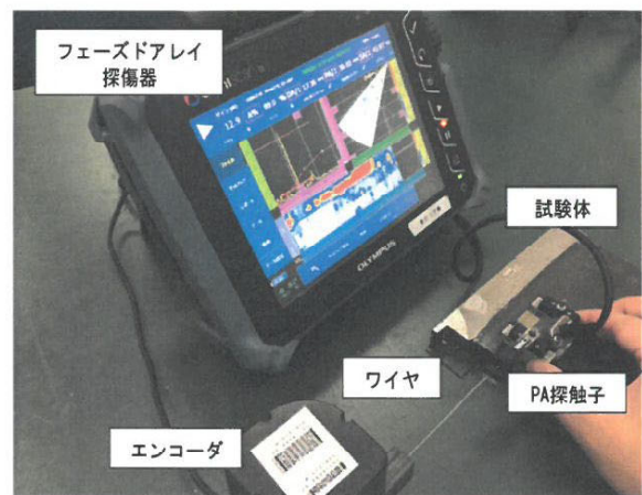
図 3.1 PA 時におけるエンコーダによる走査
